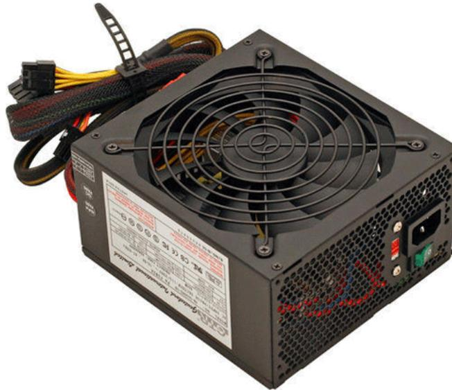
Come per ogni dispositivo elettronico, l'alimentatore fornisce alimentazione all'intera stampante 3D. Non c'è bisogno di una spiegazione elaborata per questo componente. L'alimentatore è montato sul telaio o alloggiato in una scatola controller separata insieme all'interfaccia utente, come per i notebook. È molto meglio se l'alimentatore è montato sul telaio in quanto si traduce in un ingombro complessivo della macchina più piccolo, ma allo stesso tempo aumenta le vibrazioni della macchina.
