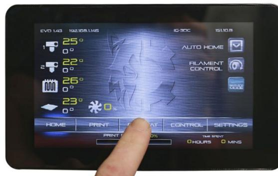
Una impresora 3D con una interfaz de usuario LCD puede funcionar como una máquina independiente. La pantalla permite controlar la impresora y leer los principales parámetros. Hay diferentes tipos de interfaces de usuario, la más común de las cuales es una interfaz LCD básica operada a través de una perilla, un dial o un conjunto de botones. Algunas impresoras 3D vienen con una pantalla táctil a todo color. En otras
