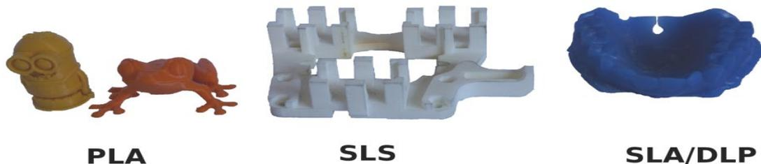
El concepto más fundamental y distintivo detrás de la impresión 3D es que es un método de fabricación aditiva. Y esta es realmente la clave, ya que la impresión 3D es un proceso de fabricación fundamentalmente diferente basado en una tecnología innovadora que crea piezas en capas de forma aditiva. Esto es radicalmente diferente de todos los demás métodos de fabricación convencionales que ya existen.
