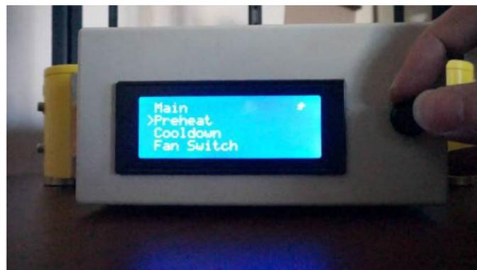
Paso 2: Espere hasta que el extremo caliente se caliente a la temperatura requerida.
